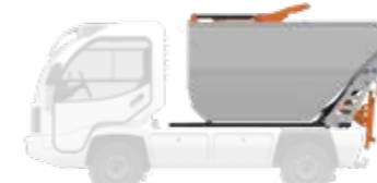
MLP - benne à déchets à haut déversement avec lève-conteneur et presse à déchets
